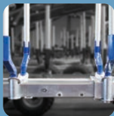
Teleskopierbarer Rahmen, verschiebbar nach der 1. Rungenbank (ausgefahren)
