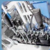
Mech. Kreuzhebelsteuerung mit E-Funktion geschlossen
