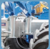
Teleskopierbarer Rahmen, verschiebbar nach der 1. Rungenbank (eingefahren)
