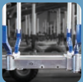
Teleskopierbarer Rahmen, verschiebbar nach der 1. Rungenbank (ausgefahren)
