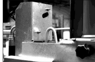
Für den Transport verwenden Sie ein ordnungsgemäßes Kettengehänge oder einen Gurt, dessen Mindesttragfähigkeit 300kg höher ist als das Eigengewicht des gesamten Holzspalters mit Zubehör.
