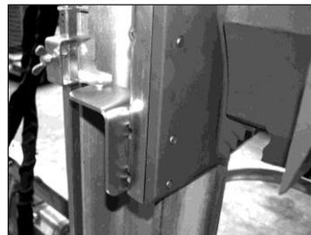
Um die Spaltlänge des Holzspalters zu verstellen fahren Sie das Spaltmesser durch drücken der zwei Handhebel in die gewünschte Höhe. Sobald Sie diese erreicht haben lassen Sie die Handhebel los. Das Spaltmesser bleibt in diese Position stehen und Sie können die Hubhöhereinstellung auf der linken Seite verstellen.
