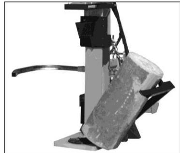
Größere Holzstämmen können mit Hilfe des seitlichen Stammhebers einfach angehoben werden. Das Messer muss dazu ganz nach unten gefahren sein. Am Spaltmesser befindet sich auf der rechten Seite ein festgeschraubter Haken.
