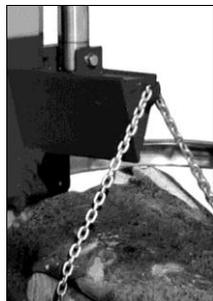
Fahren Sie mit dem Messer so weit nach unten, damit Sie das Holz problemlos anhängen können. Der Stamm muss immer im rechten Winkel zur Maschine liegen und an der Maschinen nahen Seite angehängt werden. Dazu müssen die Haken links und rechts in das Holz geschlagen werden. Anschließend wird die Kette am herabgefahrenen Messer eingehängt.
