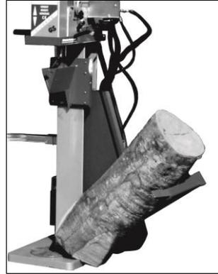
Große Holzstämme sind sehr komfortabel mit dem hydraulischen Stammheber aufzustellen. Es stehen 2 Varianten zur Verfügung. Einerseits die Variante über die Schlepperhydraulik des Traktors oder über Zapfwelle, wo alle Funktionen des Holzspalters über die Gelenkwelle angetrieben werden.
