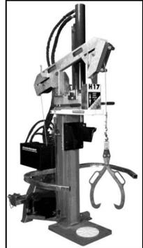
Es ist unbedingt erforderlich das Seil auf Beschädigungen zu überprüfen. Mit einem geknickten oder beschädigten Seil darf auf keinen Fall gearbeitet werden!
