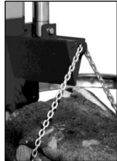
Fahren Sie mit dem Messer so weit nach unten, damit Sie das Holz problemlos anhängen können. Der Stamm muss immer im rechten Winkel zur Maschine liegen und an der Maschinennahen Seite angehängt werden. Dazu müssen die Haken links und rechts in das Holz geschlagen werden. Anschließend wird die Kette am herabgefahrenen Messer eingehängt. Dazu befindet sich an der Messervorderseite ein kleiner Haken an dem die Kette mittig eingehängt wird.
