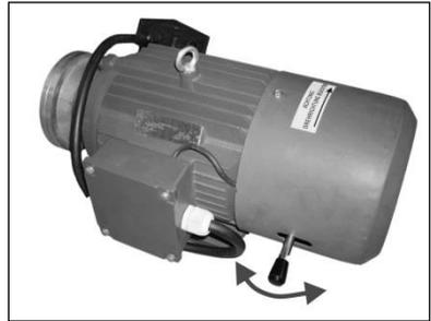
Bewegen Sie den im Bild dargestellten Bremshebel abwechselnd in beide Richtungen (siehe Pfeilrichtung).
