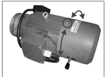
Bevor Sie das Gehäuse abziehen, müssen Sie den Bremshebel rausrauben (gegen den Uhrzeigersinn).
