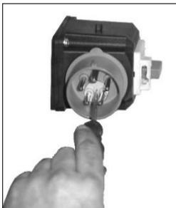
Im Stecker befindet sich ein Phasenwender, mit dem Sie die Drehrichtung des Motors wechseln können (die Scheibe im Stecker mit einem Schraubendreher hineindrücken und um 180° verdrehen).
