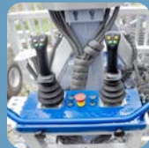
Hydr. Vorsteuerung mit E-Funktion
