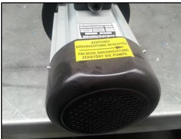
Im Stecker befindet sich ein Phasenwender, mit dem Sie die Drehrichtung des Motors wechseln können (die Scheibe im Stecker mit einem Schraubendreher hineindrücken und um 180° verdrehen).
