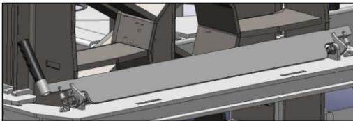
Da die Verbindung der beiden Messer gelöst wurde, fährt bei Betätigung des Steuerhebels nun nur noch das vordere Messer.
