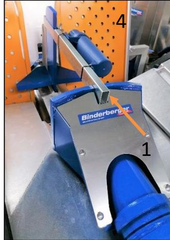
Nun ist das Halteblech (2) zu öffnen. Anschließend die Zweihandsteuerung nach oben drücken. Wenn der Zylinder ganz eingefahren ist muss er mit dem Federriegel (3) wieder fixiert werden.
