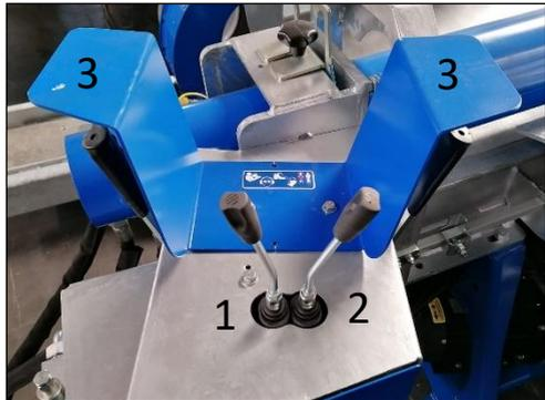
Ist das Holz gespalten so muss der Drücker wieder in seine Ausgangsstellung gefahren werden. Dazu einfach die Zweihandsteuerung (3) nach oben drücken bis sie einrastet. Anschließend können sie die Zweihandsteuerung auslassen, denn der Drücker fährt selbstständig zurück. Nun können Sie den nächsten Spaltvorgang starten.
